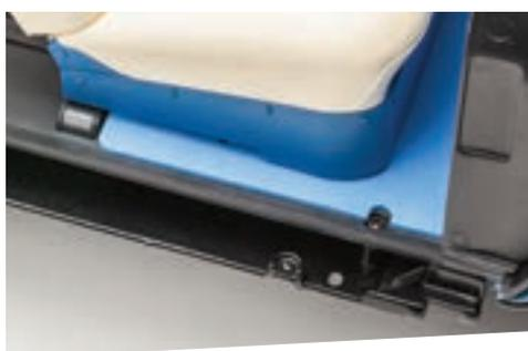
Закрепите пол салона на шасси масштабной модели при помощи четырех винтов 2,0×5 (СМ) с обеих сторон пола около оснований переднего и заднего сидений.
