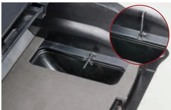
Снимите винт крепления запасного колеса с кронштейна. Отверните винт, крепящий кронштейн запасного колеса к полу багажного отсека модели.
