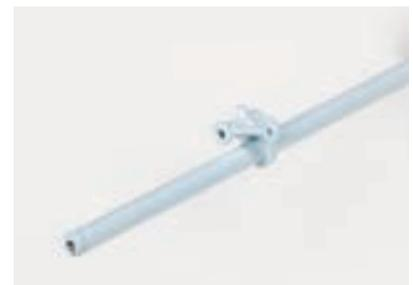
Установите на освободившийся конец вала рулевого управления кронштейн вала переключения передач. При этом фиксирующее кольцо кронштейна должно быть ориентировано в сторону передней крепежной проушины вала рулевого управления.
