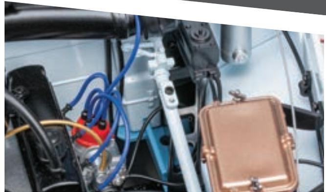
Совместите центровочные и крепежные элементы нижней и верхней частей вала рулевого управления. Закрепите детали при помощи винта 1,7×4 (AM).
