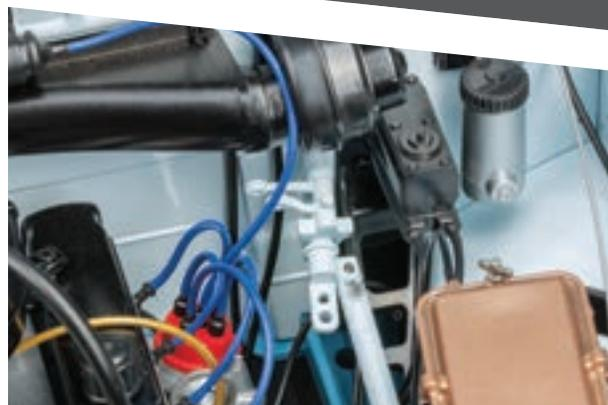
Поместите верхнюю часть вала рулевого управления в отверстие перегородки моторного отсека со стороны двигателя модели.
