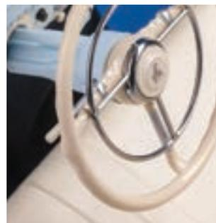
Для окончания сборки поместите рулевое колесо на вал рулевого управления. Закрепите деталь при помощи винта 1,7×5 (JM). Накройте крепежный винт снятым ранее кольцом включения звукового сигнала. Совместите крепежные штифты кольца с отверстиями рулевого колеса и плотно прижмите детали друг к другу.
